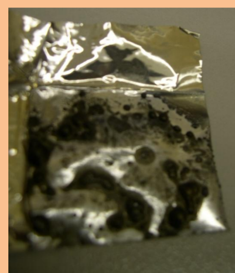
Углерод -титановая пленка после воздействия щелочи
