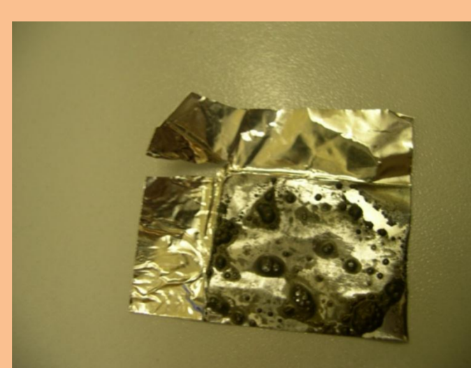
Углерод -титановая пленка после воздействия щелочи
