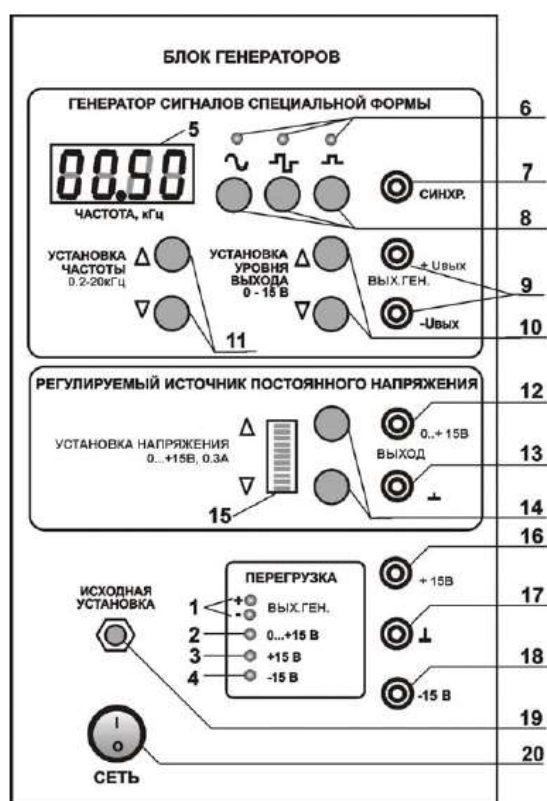
Рис. П1. Блок генераторов напряжений:
